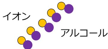
放射線が通ることにより発生したイオンが中心になって、周囲にあるアルコールが集まり、しずくができます。このアルコールのしずくが、放射線が通ったあとにできると、その連なりが霧のような「すじ」として見えます。
