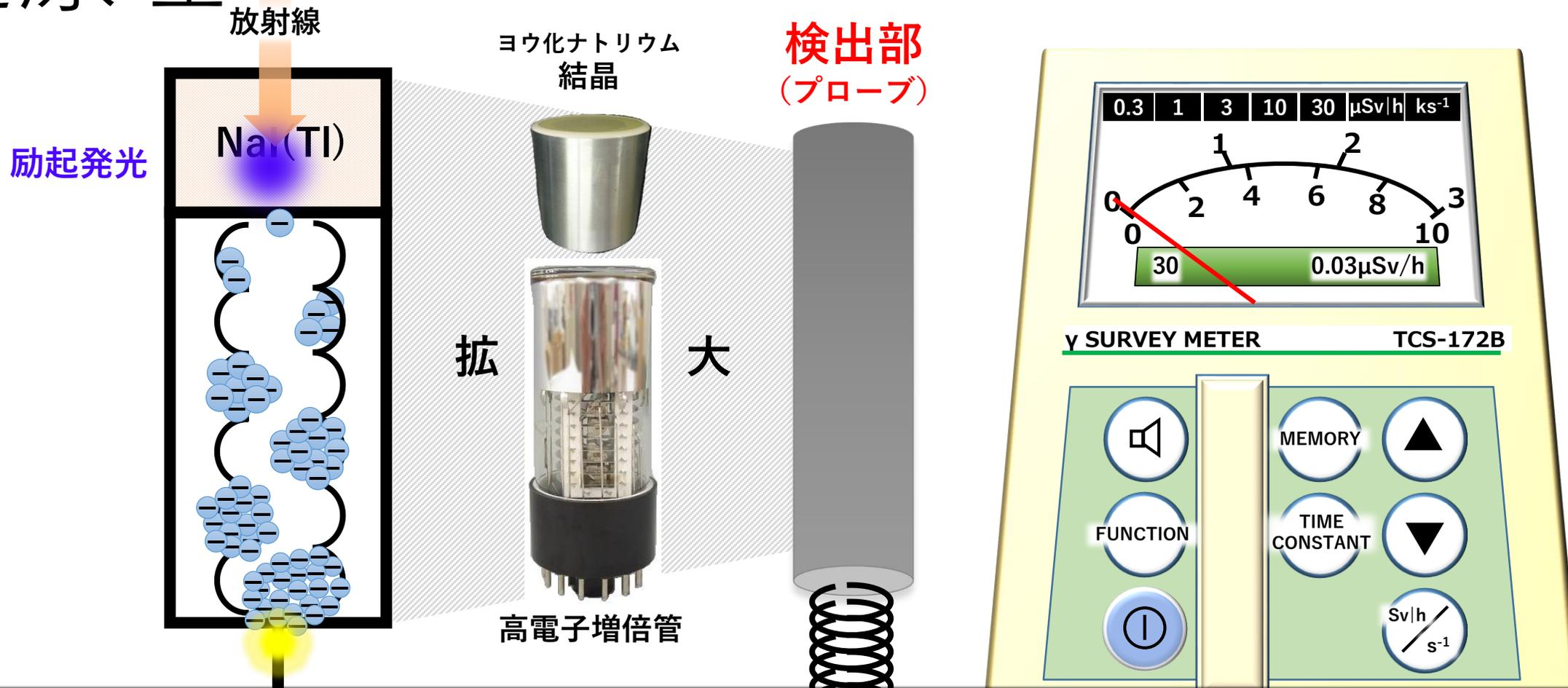
検出部の先端には、**ヨウ化ナトリウム**と呼ばれる結晶があり、放射線が入射すると光を発する。物質が発光する現象を**シンチレーション**と呼び、発光する物質のことを**シンチレータ**と呼ぶ。その光は、**光電子増倍管**によって電子に変換され、増幅された後に電気信号へと変換される。その数を数えて1秒間あたりの数に直すと**計数值** ( $\text{s}^{-1}$ )、係数を乗じて線量換算すると**線量率** ( $\text{Sv/h}$ )
